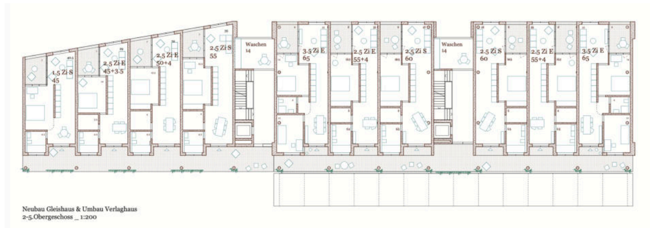
Neues Glashaus und Umbau Verlagshaus Grundriss Wohngeschoss
